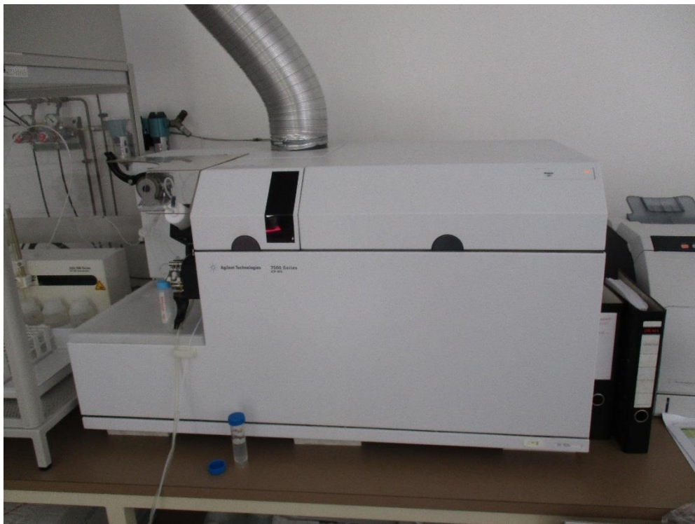
Abb. 5: Das zur Messung verwendete ICP-MS-System Agilent Technologies, ICP-MS-7500-Series. 25.7.2016; Foto: A. Michlits.
