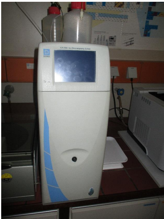
Abb. 4: Das zur Messung verwendete Ionenaustauschchromatographie-System Dionex, ICS-2000, Ion-Chromatography-System. 25.7.2016; Foto: A. Michlits.
